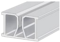
legar aluminiowy niski - rozstaw podpór max. co 60 cm
