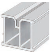
legar aluminiowy wysoki - rozstaw podpór max. co 100 cm
